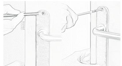
**Portes massives** : Retirer le jeu de poignées. Utiliser un foret de 2 mm pour percer un trou d'environ 1 cm de profondeur au niveau des repères. Fixer le jeu avec des vis à bois.
