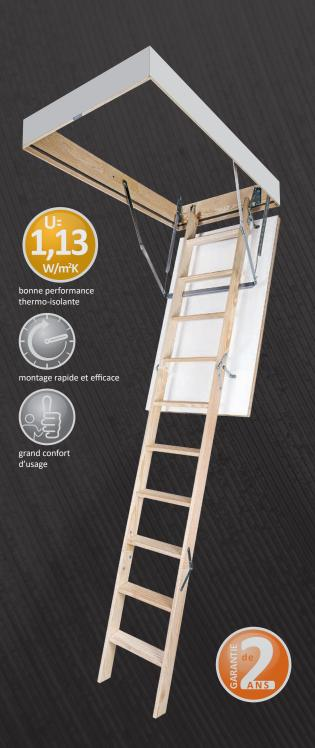
Charge admissible 150 kg Largeurde l'échelle 38 cm Profondeur des marenes 7 cm Largeur des marches 34 cm Distance entre les marches 25 cm Epaisseur trappe 3,6 cm Hauteur caisson 14 cm Coefficient de transmission thermique\* U=1,13 W/m<sup>2</sup>K
