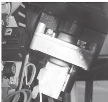
**Motoréducteur:** si le motoréducteur s'arrête, le poêle continue à fonctionner jusqu'à ce que la flamme sorte par manque de carburant et jusqu'à ce qu'il atteigne le niveau minimum de refroidissement.
