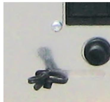
**Thermostat ambiant:** cela permet de détecter la température dans la chambre. Quand il détecte la température de consigne sur l'écran, le poêle passera en fonctionnement ECO, qui est en fonction de maintien pour économiser du carburant. Le thermostat d'ambiant doit être réparti de manière à ne pas être conditionnée par la température du corps du poêle.
