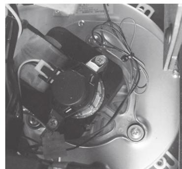
**Sonde température fumées:** ce thermocouple relève la température des fumées et fait partir ou arrête le poêle lorsque la température des fumées descend au-dessous de la valeur programmée.
