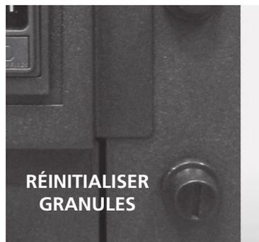
**Dispositif de sécurité température des granulés de bois:** si une température excessive se vérifiait à l'intérieur du réservoir, le thermostat de sécurité des granulés de bois à réarmement manuel générerait une alarme **"ALAR-SC-FAIL"** pour interrompre le fonctionnement de le poêle. Le rétablissement doit être effectué par le client en réarmant ce dispositif placé derrière l'appareil.
