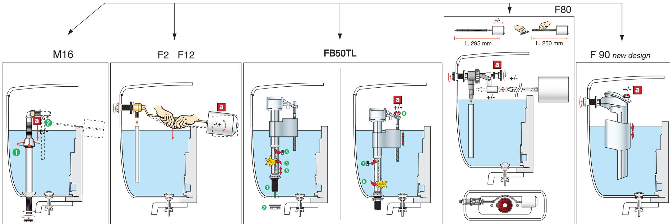
Pour régler la quantité d'eau évacuée, régler le niveau haut d'eau dans le réservoir avec le robinet de remplissage. **a**
