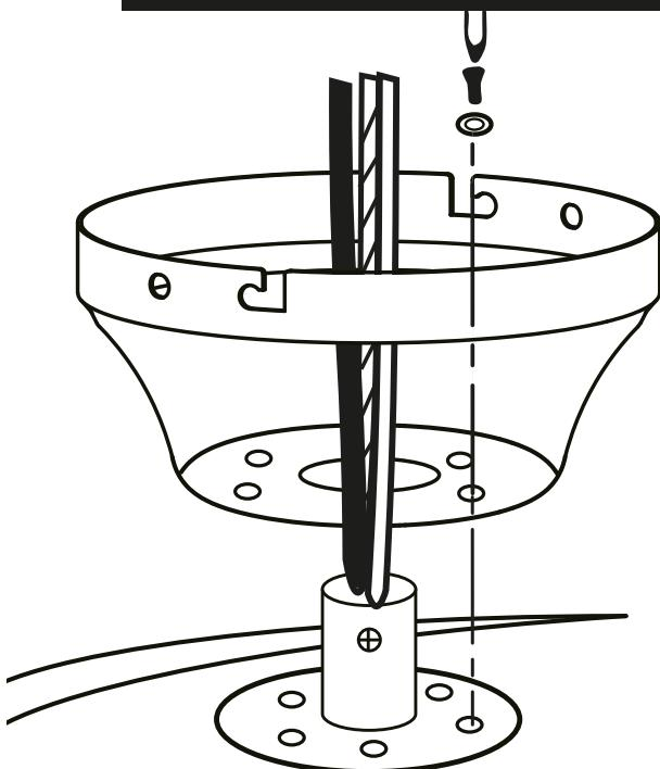
5] Steek de bedrading door de afdekkap. Bevestig de afdekkap direct aan de motorbehuizing door middel van de bijgeleverde ringen en schroeven. Draai de schroeven goed vast. Ga naar stap 9.
