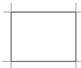
Zaag eerst langs de aangebrachte lijnen aan de voorzijde, maar zaag de tegel niet helemaal door. Een diepte van ca. 2-3 mm is voldoende. Draai vervolgens de tegel om en zaag de vorm aan de achterzijde uit. Omdat de slijpschijf rond is, zal de zaaglijn aan de voorzijde iets korter zijn dan aan de achterzijde. Trek daarom de zaagsnede aan de achterzijde iets door (zie de stippellijn in de navolgende tekeningen) totdat de hoek aan de voorzijde volledig is uitgezaagd.
